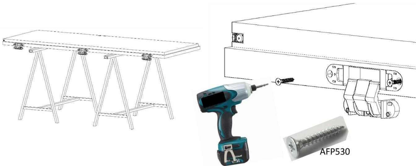
12. Accrocher la porte sur le dormant côté paumelles à l'aide des coussins gonflables. Visser modérément les vis de maintien avec la clé *Allen* fournie dans le kit afin de permettre le réglage des paumelles par la suite.
