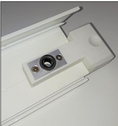
Mise en place du gabarit de perçage sur le profil coupé à 45°
